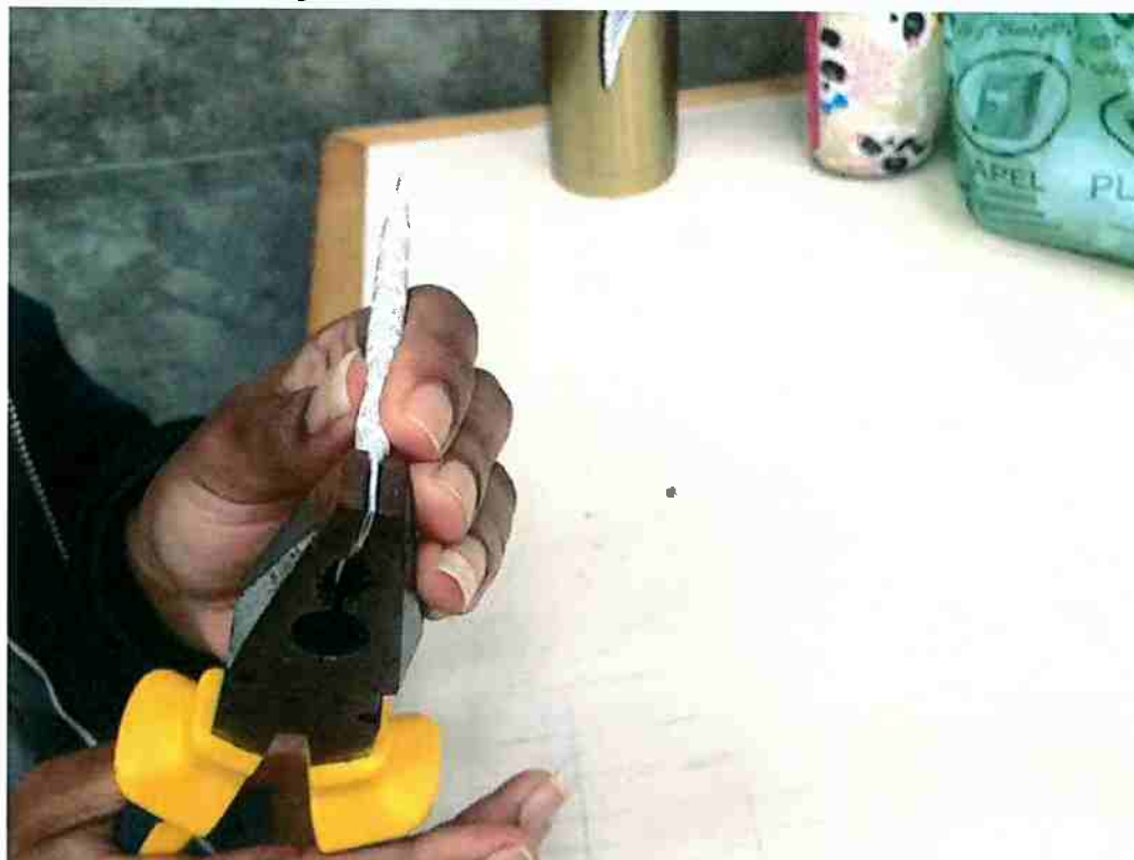
Figura 8 - Achatamento da extremidade do canudo.
