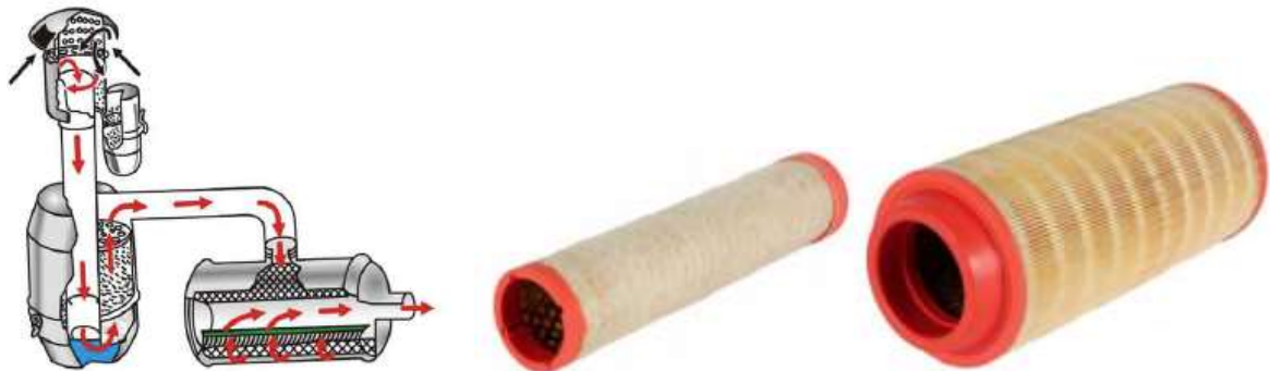
Figura 8 – Na esquerda, passagem do ar pelo pré-purificador e filtro de ar, no centro elemento filtrante de segurança e na direita elemento filtrante principal, que deve ser periodicamente limpo e verificado quanto à presença de fissuras.
