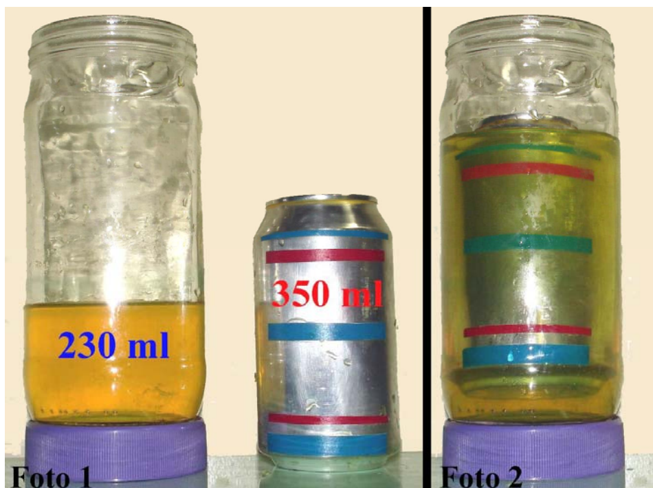
Figura 1 – Paradoxo de Galileu: corpo flutuando em um recipiente onde não existe o volume de líquido requerido pelo enunciado tradicional da Lei de Arquimedes.
