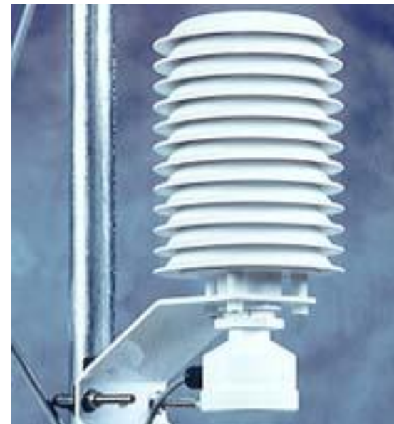
Abrigo meteorológico – Estação Automática
