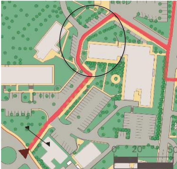
Comparando com a planta a cima, nota-se que vagas de estacionamento foram retiradas para originar calçadas. Na área destacada a via para carros é compartilhada com as bicicletas, uma vez que por causa do relevo, não é possível ampliar a área da calçada, tampouco construir uma ciclovia.
