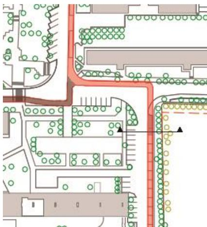
Figura 72- Ciclovía ao lado do edifício E1. Indicação do Corte 8. Ao lado o Corte 8 (imagem do autor)
