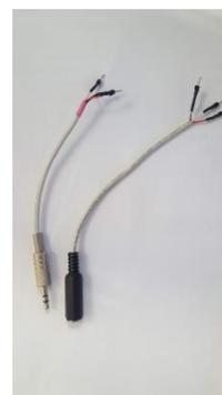
montagem feita com cabos preparados para protoboard (essa montagem não é comercial!)
