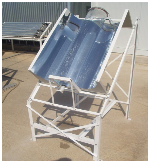
Figura 12. Reator em batelada com capacidade de 25 L para desinfecção da água.
