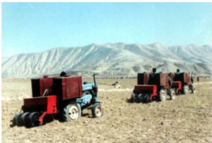
Figura 8. Máquina semeadeira funcional integrada com irrigação durante a semeadura
