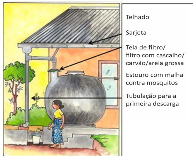
Figura 4. Componentes de um sistema típico de captação de água de chuva no Sri Lanka (RCWSSP & Fraser Thomas Ltd., 2006)
