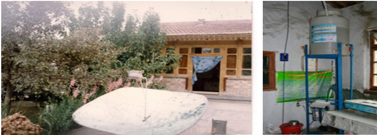
Figura 6. Fogão solar para ferver água (à esquerda) e equipamento de purificação de água da chuva (à direita)
