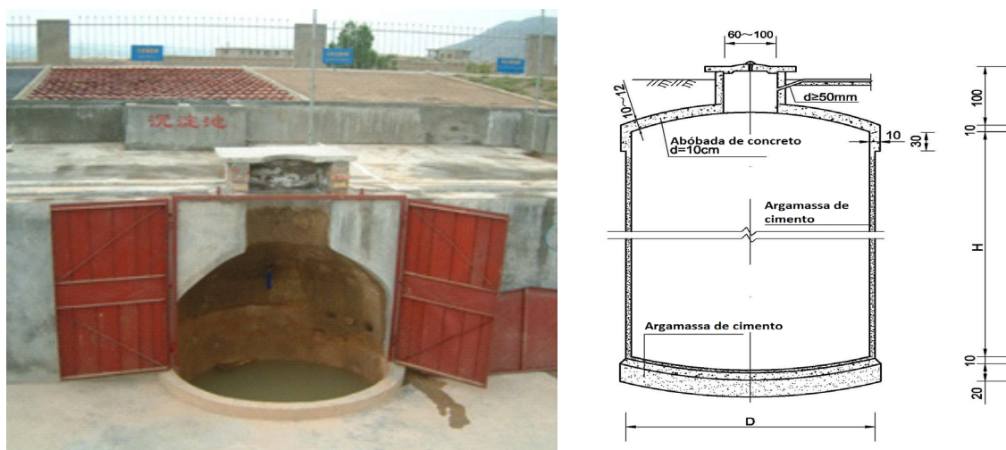
Figura 3. Um modelo de "caverna d'água" para demonstração e ilustração por um corte transversal
