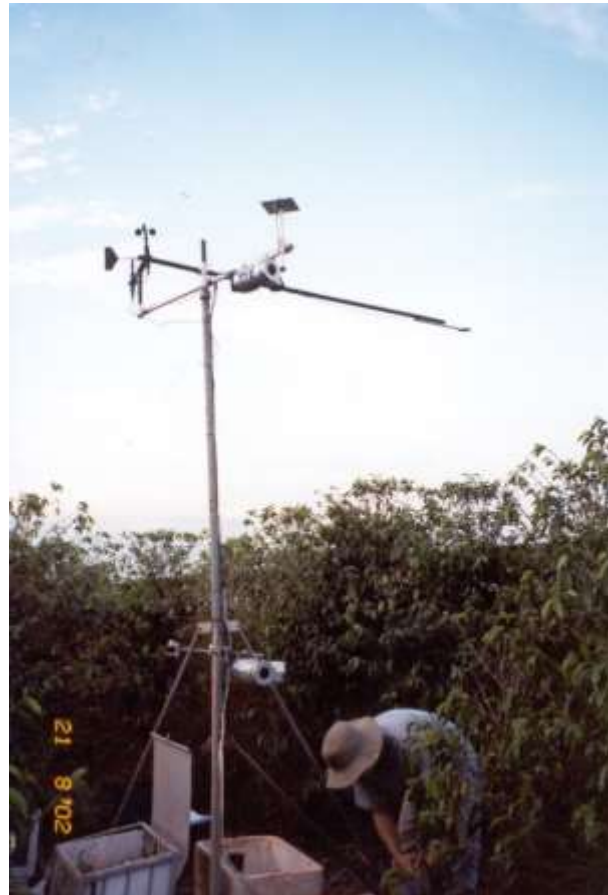
Medida da ETc com o Sistema de Razão de Bowen em Cafezal
