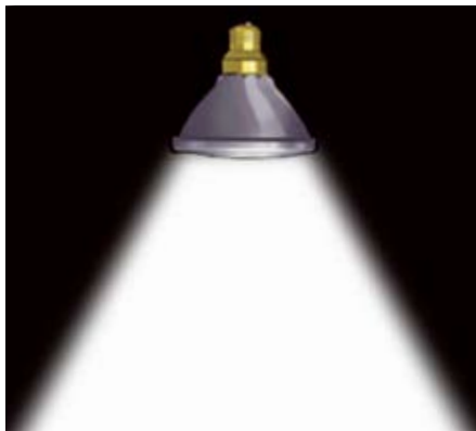
Figura 30 - Ângulo de abertura FLOOD 38°
