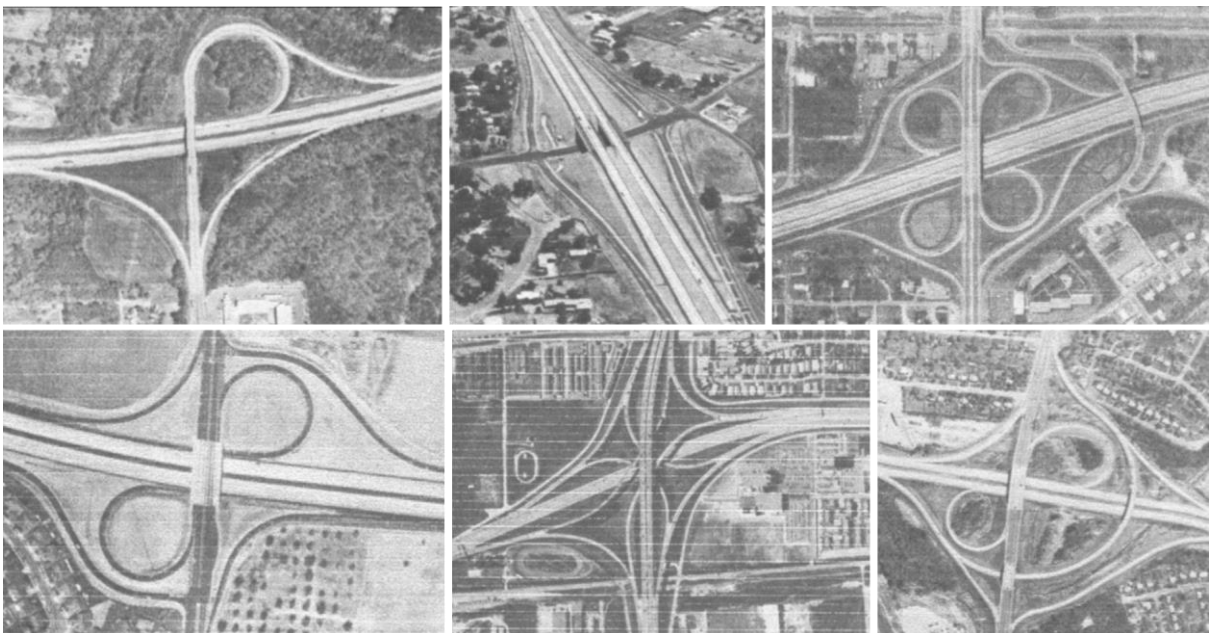
Figura 2.6 - Tipos de interseções em níveis diferentes: trombeta, diamante, trevo completo, semidirecional, direcional e trevo parcial (sentido horário, a partir da fotografia do canto superior esquerdo)
