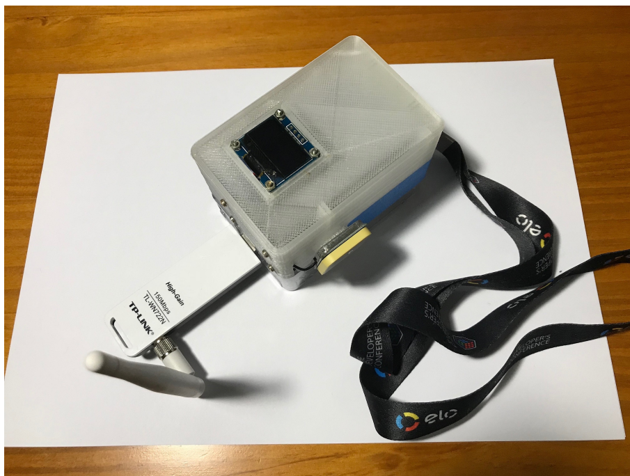
Figura 6 – Versão final do protótipo do contador automático de passageiros
