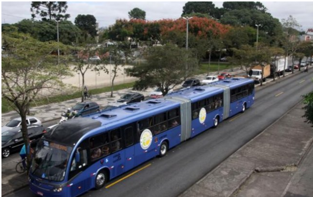
Figura 1 – Veículo biarticulado, com 28 metros e capacidade para 270 passageiros do sistema BRT de Curitiba
