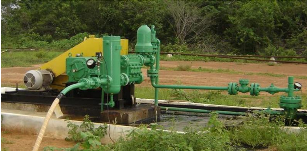
Figura 8 – Vasos amortecedores de fluido principal de bomba
