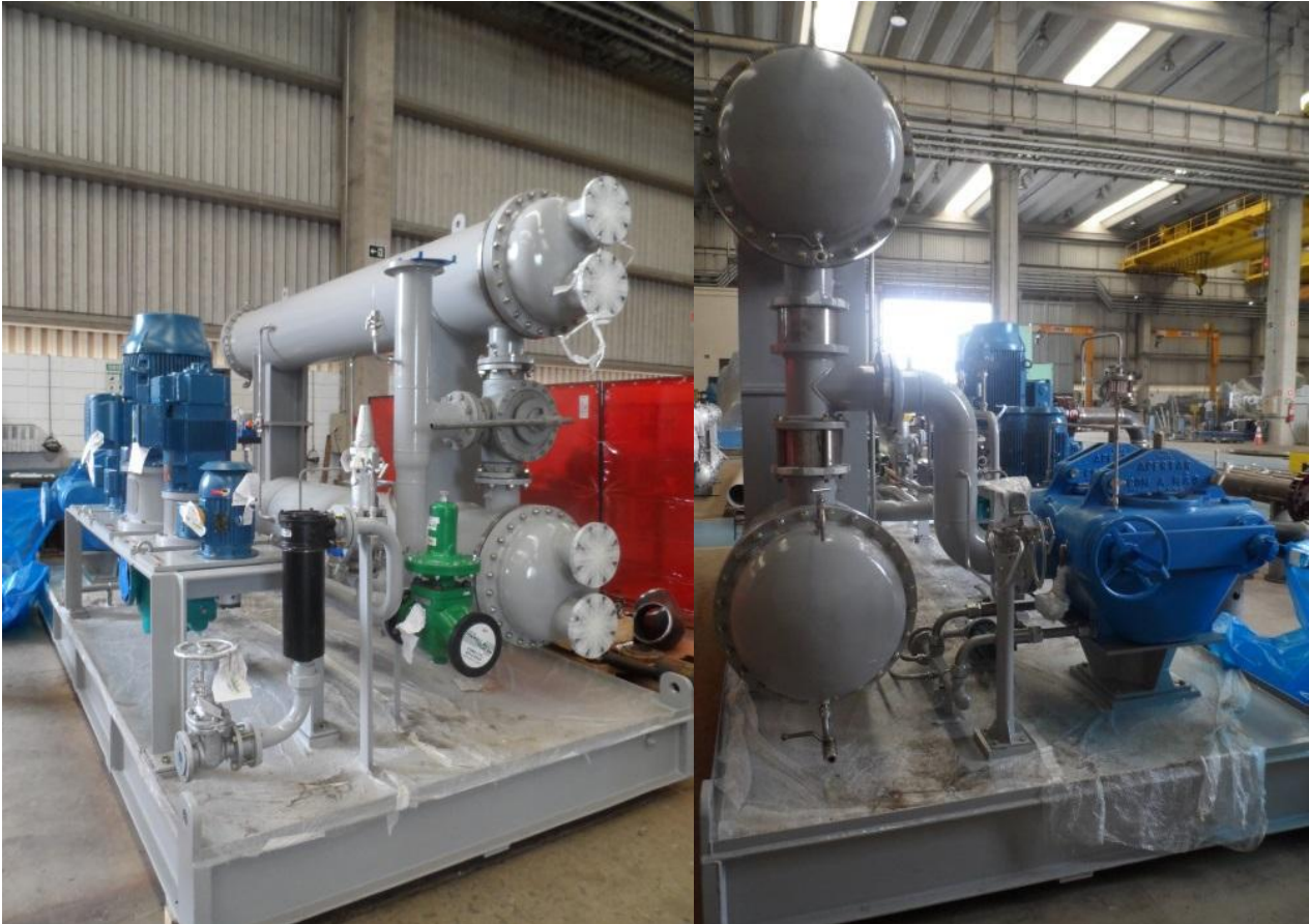
Figura 6 – Vaso de pressão de sistema de lubrificação de turbinas a vapor, fornecido com skid independente
