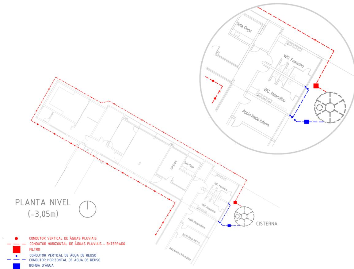
**Figura 22.** Aproximação do local de intervenção - detalhamento do sistema no segundo nível.
