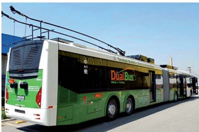
Dual-Bus – veículo elétrico puro / trólebus.
