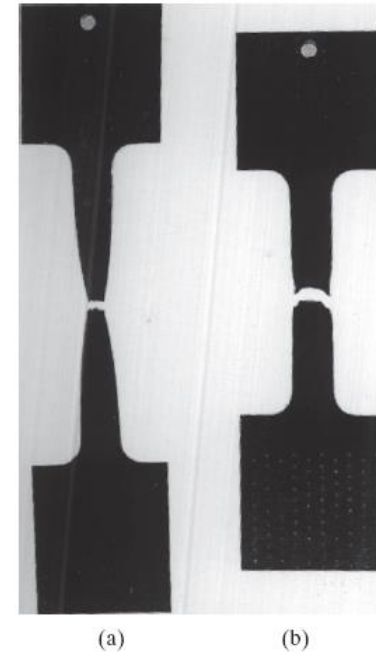
Figura 1.19 Contraste no comportamento mecânico do (a) alumínio (relativamente dúctil) e (b) magnésio (relativamente frágil) resultantes da estrutura em escala atômica mostrada na Figura 1.18. Cada amostra foi puxada com tensão até ser fraturada. (Cortesia de R. S. Wortman.)
