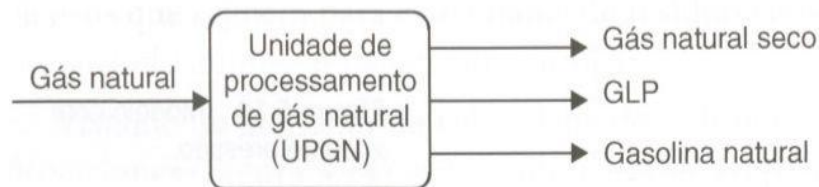
Figura 15 Entradas e saídas típicas de uma UPGN.
