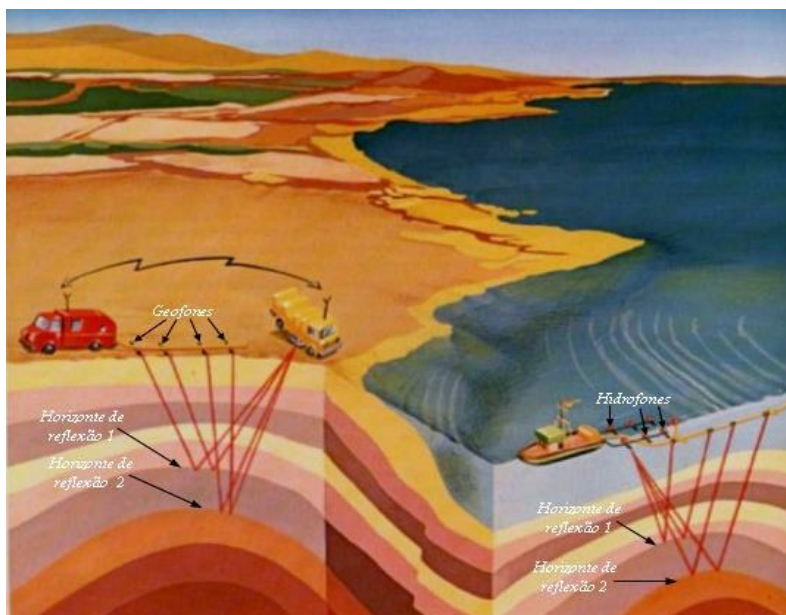
Figura 10 Exploração sísmica em terra e mar.
