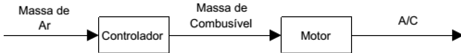
Figura 6 – Diagrama de blocos do sistema em malha aberta.
