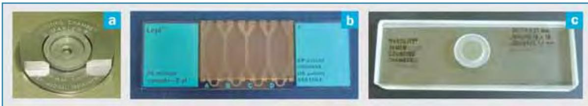
Figura 4. Câmaras de contagem utilizadas para análise da motilidade espermática: (a) câmara de Makler; (b) Microcell; (c) Horwell.
