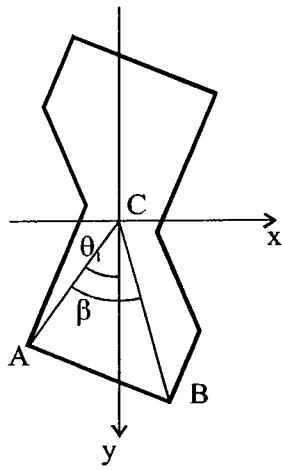
b. Na seção onde  $M_{\max}$  vale  $2M_0$  (qualquer seção entre os momentos aplicados de  $2M_0$  e  $3M_0$ ):  $\sigma_{\max} = \sigma_B = 2,80 \text{ kN/cm}^2$
