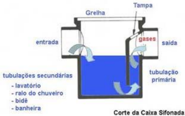
Corte da Caixa Sifonada
