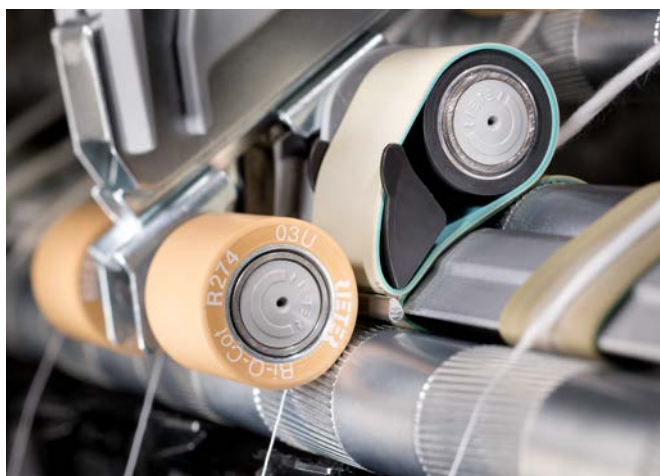
Orientação precisa da fibra no trem de estiragem
