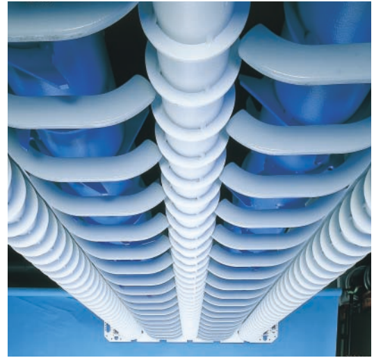
A produção é distribuída a dois cilindros de abertura. Três cilindros de suporte garantem um posicionamento seguro dos fardos
