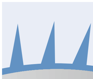
De cilindro a cilindro, ângulos mais acentuados dos dentes das garnições
