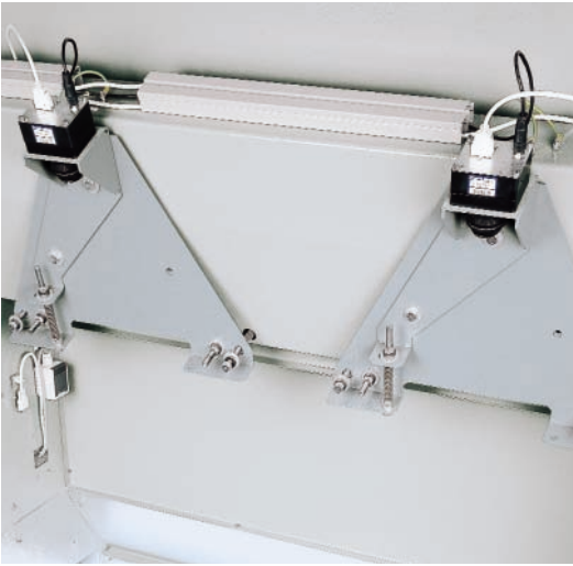
Duas câmeras digitais exploram o véu sobre o cilindro de abertura e detectam partes estranhas
