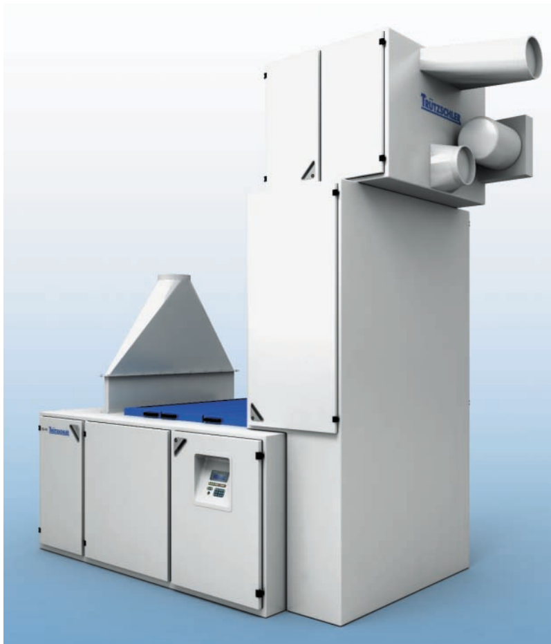
O abridor TUFTOMAT TO-T 4 foi construído para grau de abertura muito alto
