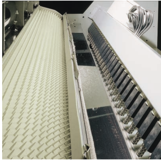
32 bicos de ar comprimido separam seletivamente as partes estranhas através do sopro, encaminhando-as a uma aspiração independente
