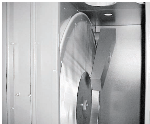
O disco de pré-filtragem com peneira metálica e bico de aspiração
