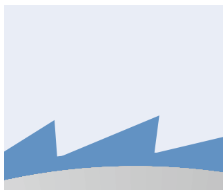
De cilindro a cilindro, ângulos mais acentuados dos dentes das garnições
