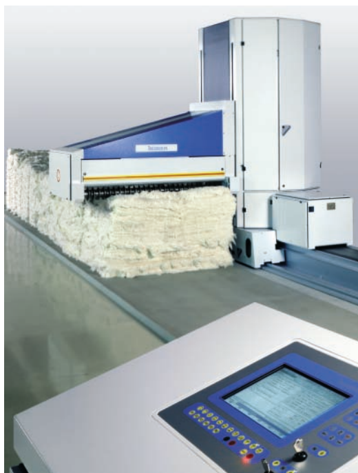
O comando das máquinas do BLENDOMAT BO-A visualiza os processos de trabalho
