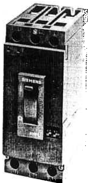
Disjuntor tripolar a seco 3VE4, Siemens, com relé térmico bimetálico ajustável, relé magnético não ajustável, relé de subtensão (bobina de mínima) e relé de disparo (para acionamento a distância).
