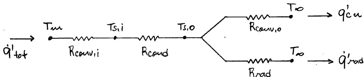
$$\dot{q}'_{tot} = \dot{q}'_{con} + \dot{q}'_{rad} \quad (\text{con} = \text{convecção natural})$$
