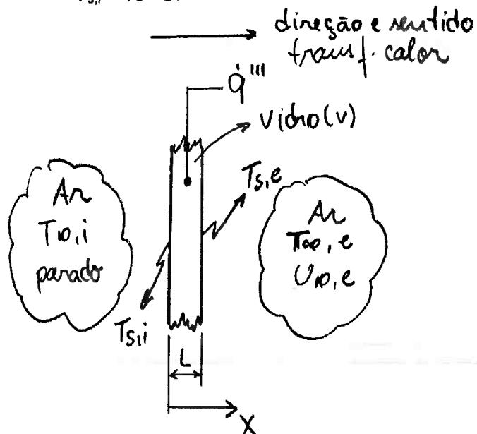
$$p/\text{vidro a } 300\text{ K: } k_v = 1,4 \text{ W/m.K}$$
