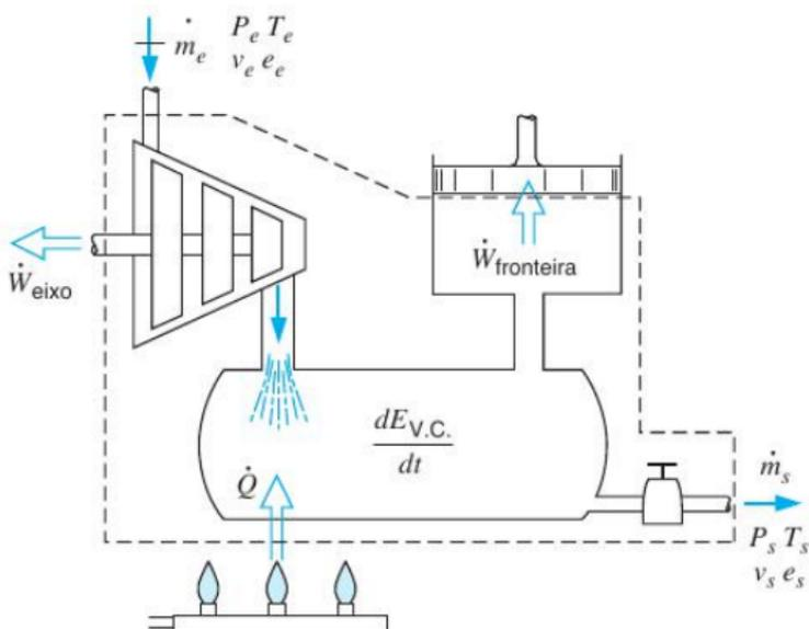
Figura: Diagrama esquemático. Principais termos envolvidos num VC.
