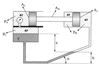
5- Na instalação da figura, determinar uma relação para  $\gamma$  em função das leituras manométricas A e B e de  $\gamma_{\rm A}$  e  $\gamma_{\rm B}$ .
