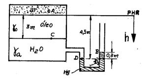
2- Determinar a diferença de pressão entre a tubulação de água e a tubulação de óleo mostrada na figura. (S é a densidade relativa, em relação à água, dos fluidos indicados)
