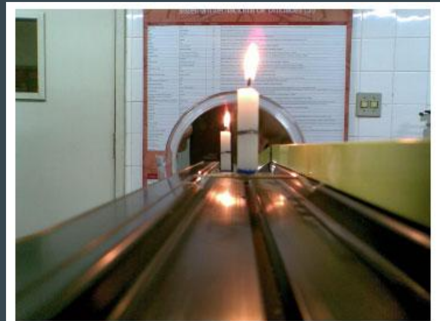
Figura 5 - Reprodução experimental da Fig. 2. A vela acesa (objeto) está colocada entre o vértice e o foco do espelho na posição p = 25\text{ cm} . A máquina fotográfica (observador) está sobre o eixo principal na posição x = 50\text{ cm} . O aumento linear transversal (AL) da imagem vale 2. Porém, percebe-se que a imagem fotografada é duas vezes menor do que o objeto.
