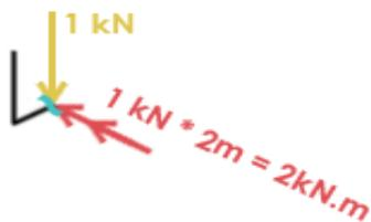
Como já dito anteriormente, aplicar a mesma força cortante em dois pontos diferentes de uma mesma viga não é a mesma coisa. Assim, aparece um momento quando se transfere uma força cortante de uma seção transversal para outra. Ao se transferir a força de 1 kN da extremidade livre para C1, surge o momento de  $1\text{ kN} \cdot 2\text{ m} = 2\text{ kN.m}$ . A direção desse momento é obtida lembrando que a força 1 kN está na direção z, a distância
