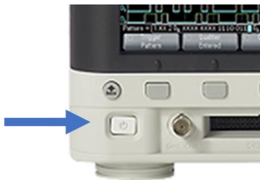
Figura 5 – Botão para ligar ou desligar o osciloscópio.
