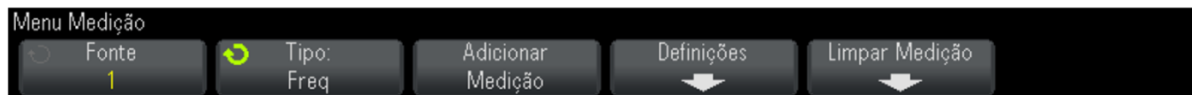
Figura 18 – Exemplo de menu de seleção de opções de medições automáticas através de softkeys.
