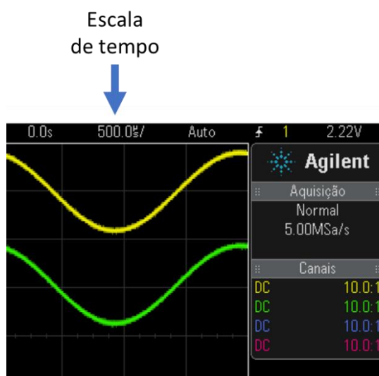
Figura 10b - Indicação da escala de tempo na tela do osciloscópio.
