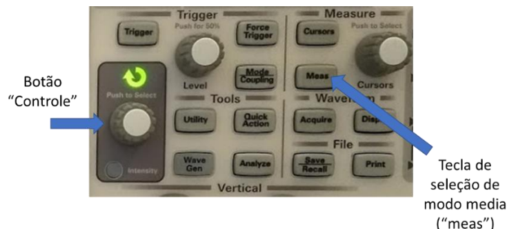
Figura 17 – Botões de seleção de medidas automáticas.
