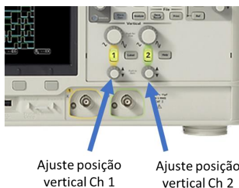
Figura 9 – Botões de ajuste de posição vertical do sinal na tela do osciloscópio.
