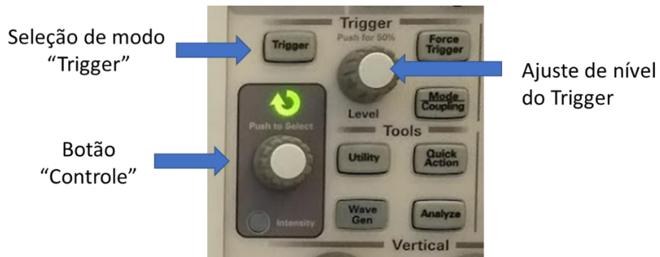
Figura 15 – Botões para seleção de modo Trigger e ajuste do nível de Trigger
