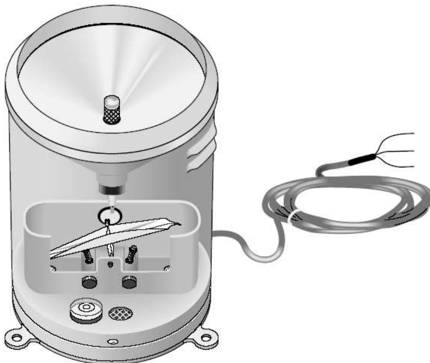
Figura 12 – Vista interna de um pluviômetro modelo CSI TB4 Rain Gauge
