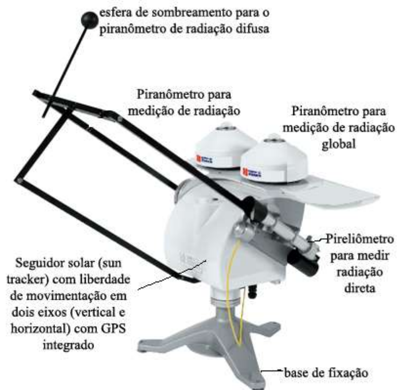
Figura 1 - Seguidor solar com sensores de radiação
