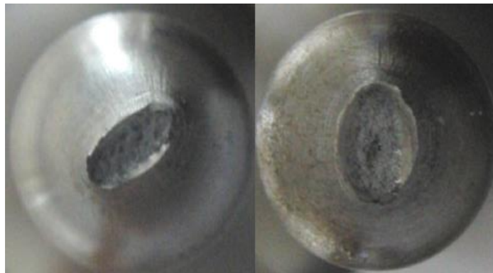
Figura 1 – Fratura de um aço grau X100 (Mirone e Corallo, 2013).
