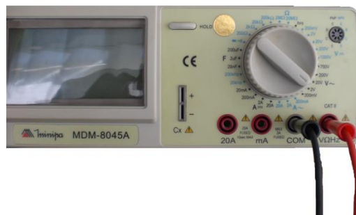
Cabos para o modo medida potencial
