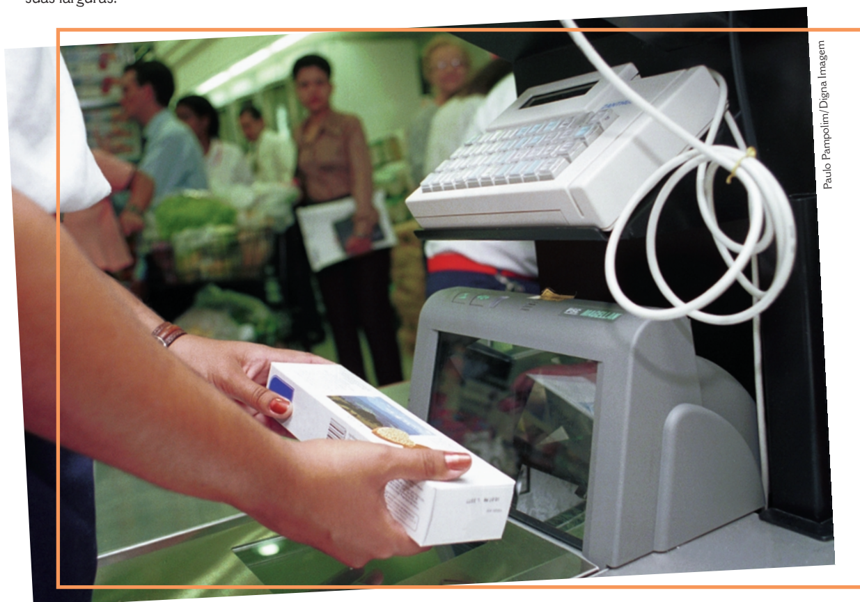
A luz produzida pela fonte luminosa incide no código de barras. Ao ser refletida, atinge a fotocélula, gerando um sinal elétrico, cujas características dependem da distância entre as listras e de sua largura.
