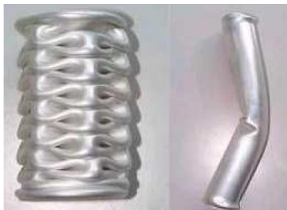
Figura 7. Flambagem (a) progressiva e (b) global
