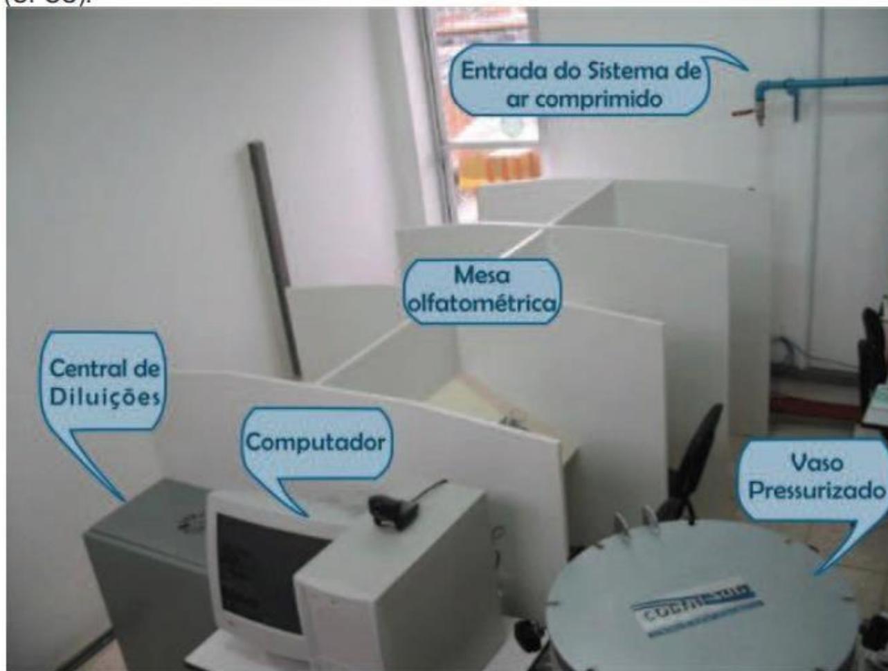
Figura 9: Componentes do olfatômetro ODILE 2000, instalado no Laboratório de Controle da Qualidade do Ar (LCQAr) da Universidade Federal de Santa Catarina (UFSC).
