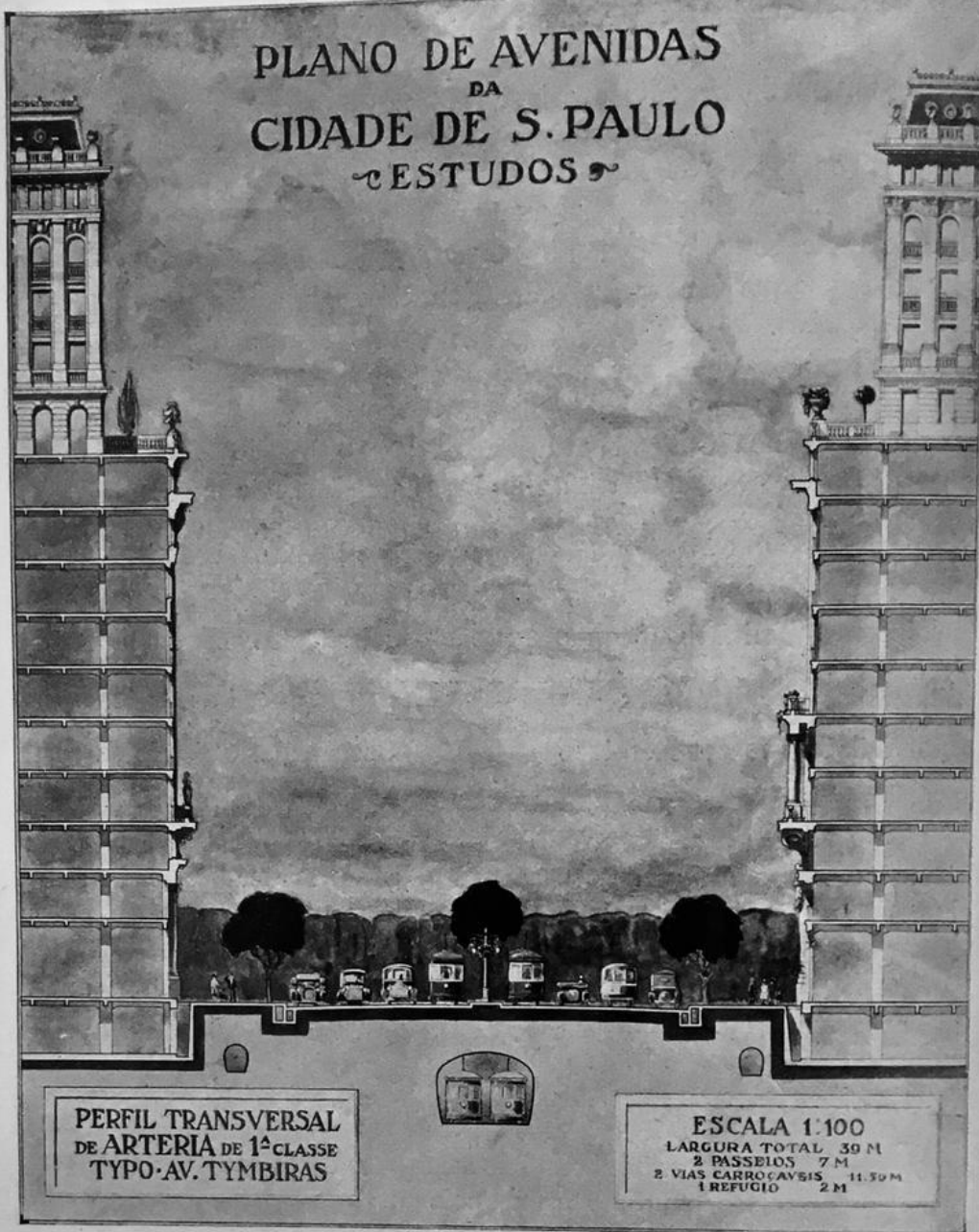
Fig. 70 — Secção mínima de arteria central de 1.ª classe
