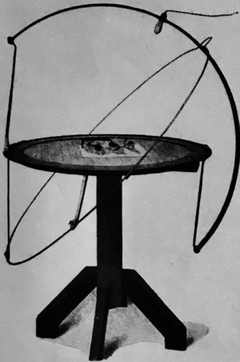
Fig. 215 — O aparelho Prausnitz-Benndorf, que permite a verificação immediata de insolação sobre modelos reduzidos
