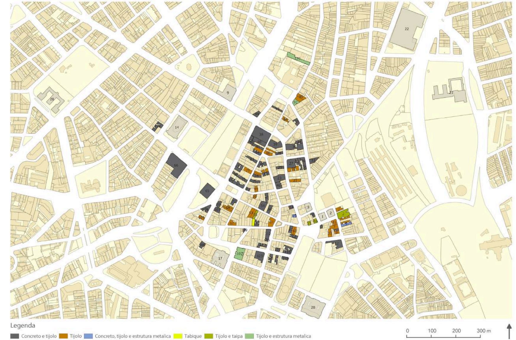
Fig.449 Materiais, técnicas e sistemas construtivos: em preto, destacam-se os imóveis construídos de concreto e tijolo; em vermelho, os de estrutura de tijolo autoportante; em verde, os de tijolo e taipa. Mapa Digital da Cidade (2004-2006) – Prefeitura do Município de São Paulo.
