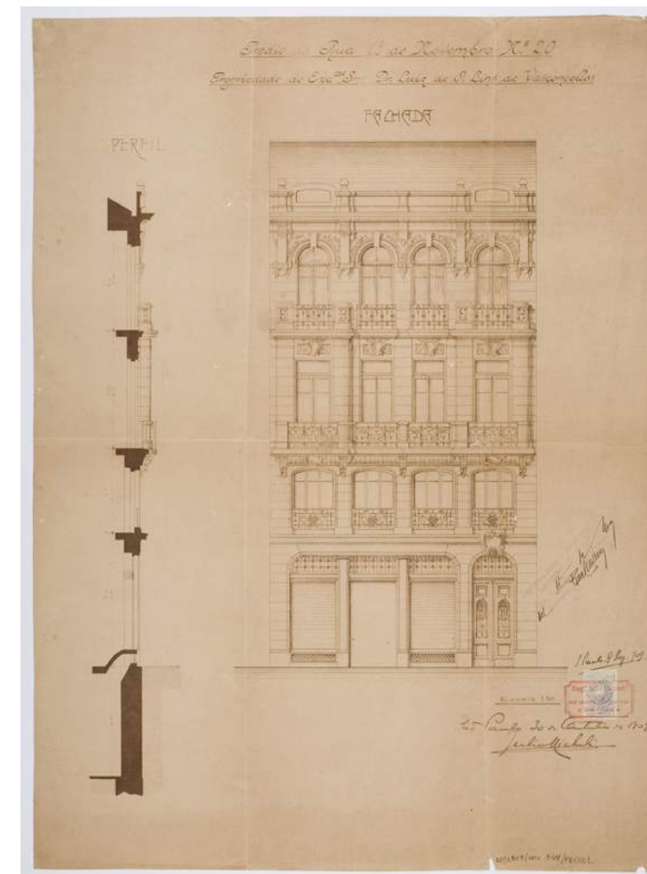
Figs.152 a 154 Edifício projetado por Julio Micheli para o advogado Luiz de Oliveira Lins de Vasconcellos. De tijolo e uso misto, mesclava lojas no térreo, oficinas na sobreloja e salas nos andares superiores (OP 1909-001.864- Pr. 1-3).
