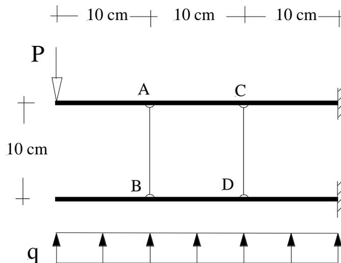
Resp.:  $N_{AB} = -2,16 \text{ kN}$ ;  $N_{CD} = 0,71 \text{ kN}$ .
