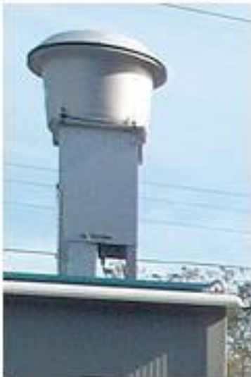
Amostrador de grande volume acoplado a um separador inercial de partículas para determinação da concentração de partículas inaláveis ( MP_{10} ) em suspensão na atmosfera
