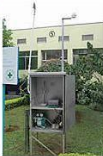
Estação tipo OPS/OMS para determinação da concentração de fumaça na atmosfera
