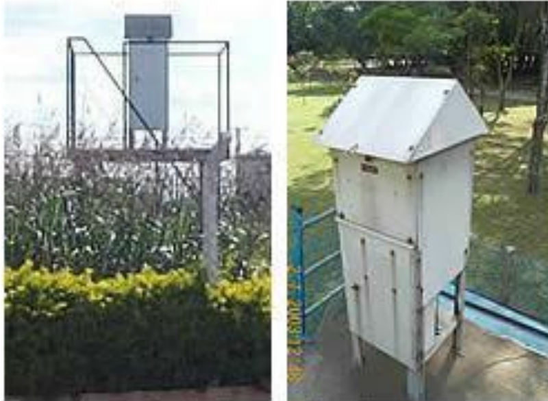
Amostrador de grande volume para determinação da concentração de partículas totais em suspensão
