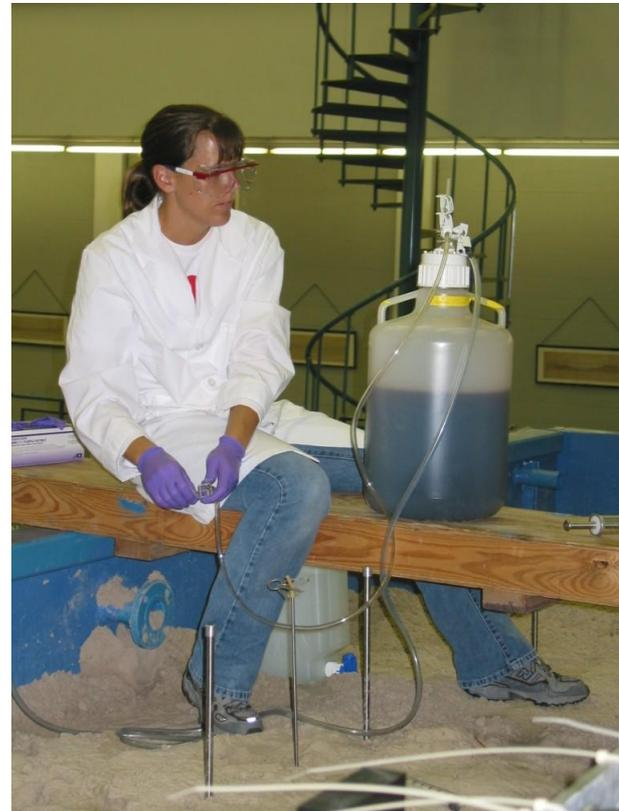
Containers pressurizados são utilizados para transportar o consórcio bacteriano. Bioaugmentação ocorre através da transferência do inóculo diretamente nos poços de injeção. O processo é realizado utilizando pressurização e gases inertes, eg.: N<sub>2</sub>
