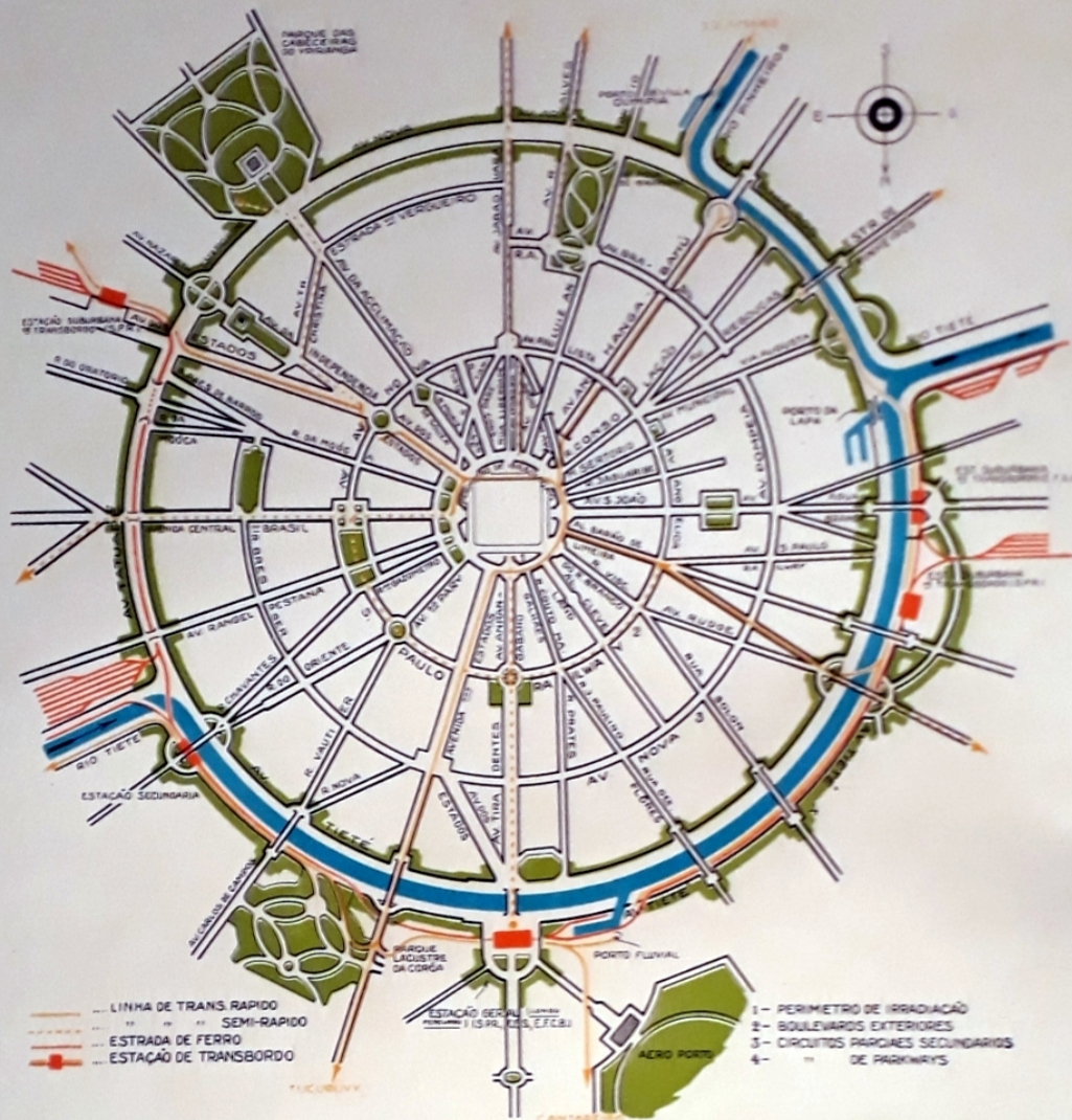
Fig. 57 — Schema teórico de São Paulo De conformidade com o presente estado. É caracteristicamente um schema radial-perimetral.
