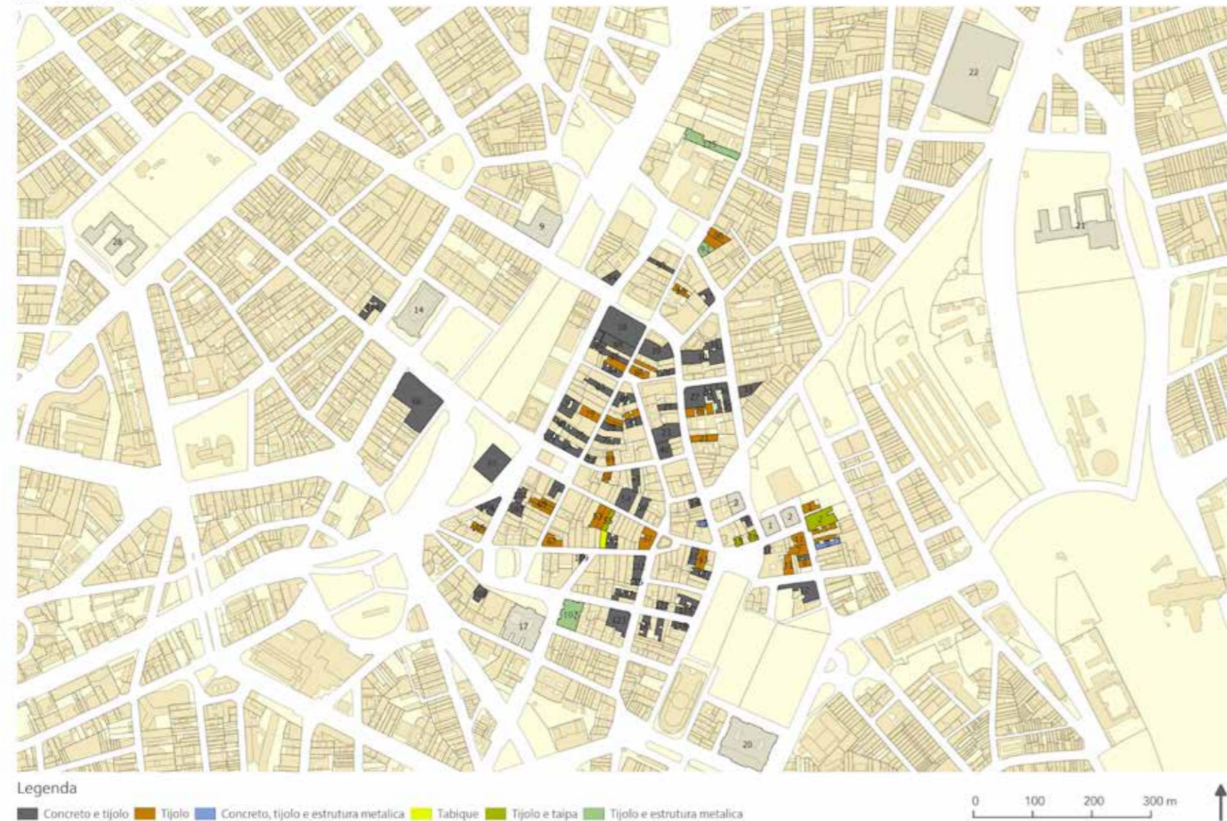
Fig. 54. Material, técnica e sistema construtivo dos 125 imóveis eleitos para estudo: preto (concreto), ocre (tijolo), azul (concreto, tijolo e estrutura metálica), amarelo (tabique), verde musgo (tijolo e taipa) e verde bandeira (tijolo e estrutura metálica). Espacialização dos dados por meio do Quantum GIS no Mapa Digital da Cidade de São Paulo de 2004-2006 . Prefeitura do Município de São Paulo. Prancha elaborada pela autora, com auxílio da bolsista de iniciação científica Marina Gonçalves Marques (CNPQ).
