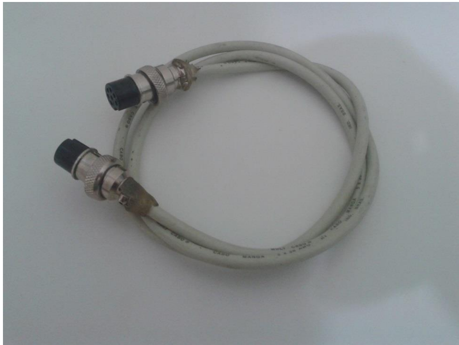
Figura 3.5.2: Cabo usado para conexão do acelerômetro com o sistema.
