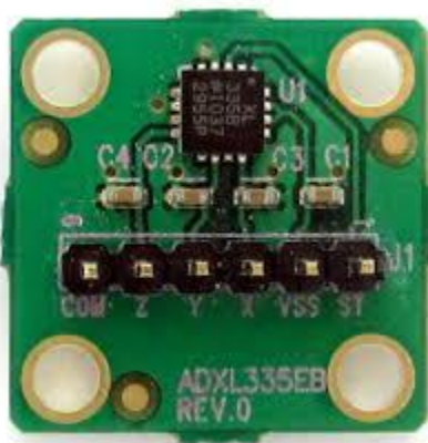
Figura 3.1.1: Board comprada com o acelerômetro já soldado. Fonte: Analog Device.
