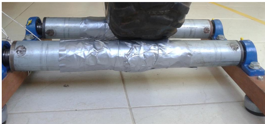
Figura 3.4.1: Foto do rolo já com a rugosidade.
