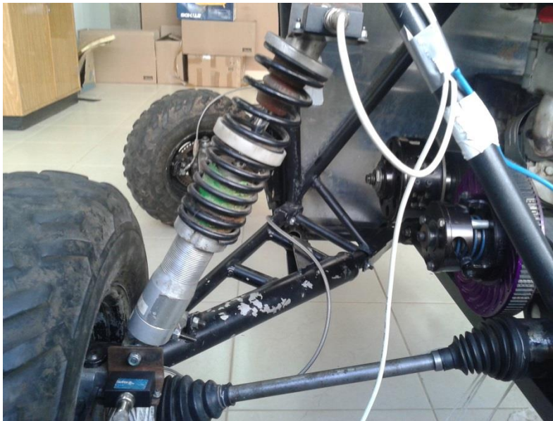
Figura 4.2.1: Foto para mostrar o posicionamento dos acelerômetros para fazer a validação.
