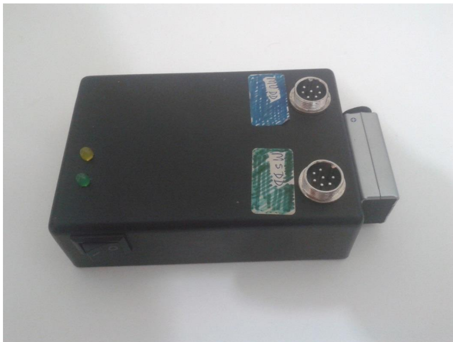
Figura 3.5.3: Caixa final do sistema de aquisição de dados.
