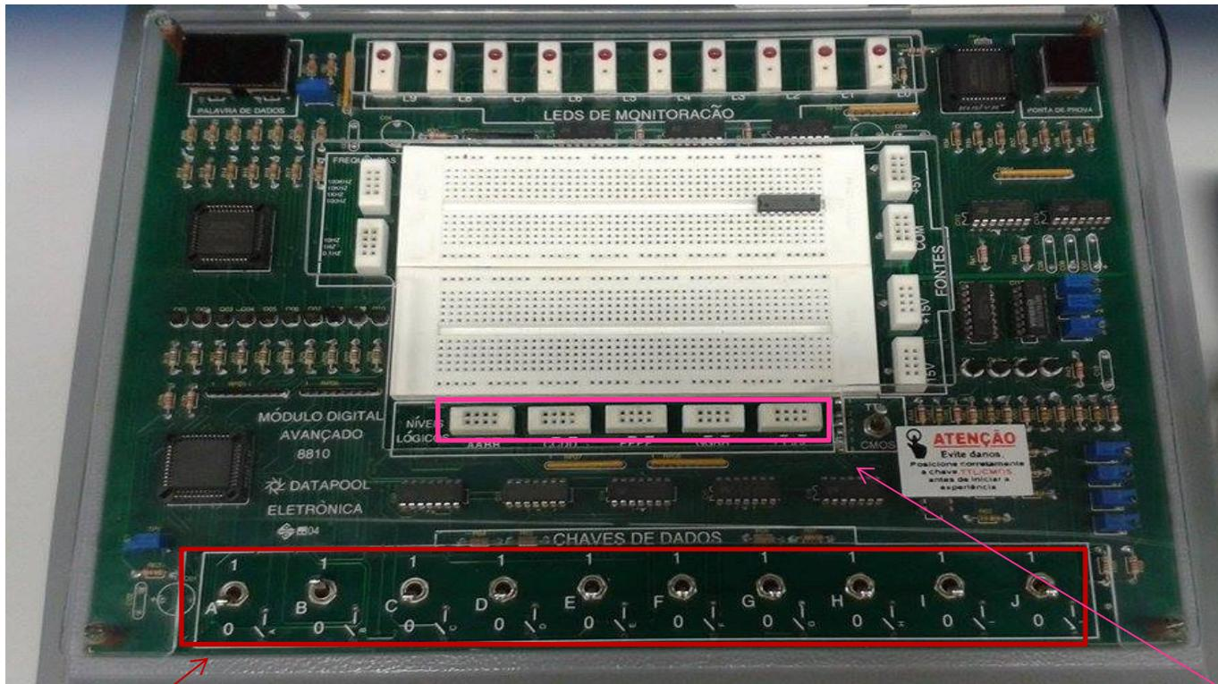
10 **chaves** ( A a J) que fornecem nível alto ("1") e nível baixo ("0") na saída do **bornes** e também seu valores barrados(invertidos) para serem ligadas nas entradas dos circuitos ou portas lógicas
