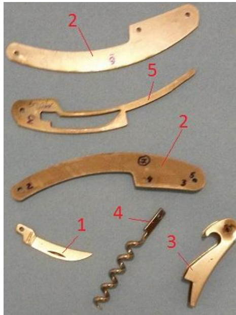
Figura 1.7.1: Indicação de cada componente do conjunto.
