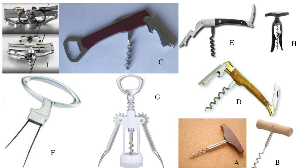
Figura 1.1.1: Diferentes modelos de saca-rolhas: A) saca-rolhas simples com mecha cheia; B) saca-rolhas simples com mecha em rabo de porco; C) limonadier; D) faca de sommelier; E) saca-rolhas com duas pontas; F) saca-rolhas de lâmina dupla; G) saca-rolhas com alavanca; H) saca-rolhas screwpull; I) saca-rolhas sveid.
