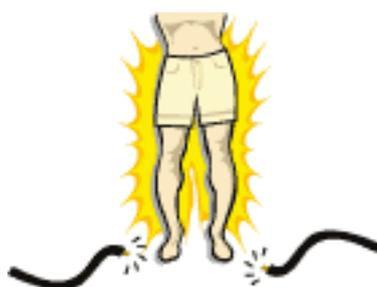
Fig. 3.5 – Percurso da corrente quando do contato entre dois pés.
