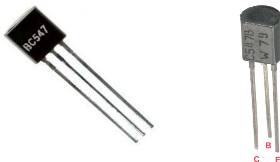
(a) Transistores em encapsulamento TO-92.
