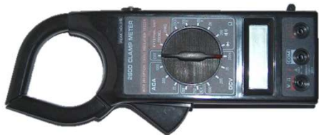
Amperímetro de alicate, para uso específico em circuitos de corrente alternada
