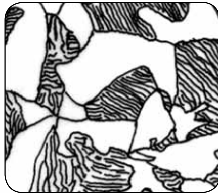
Microestrutura de um aço com 0,4% C. Ferrita e Perlita
