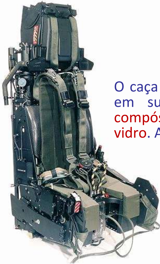
Assento ejetável: partes estruturais em fibra de carbono.
